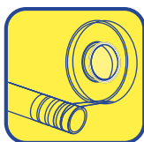
Omatajte traku u smjeru navoja i blago zatežite traku
